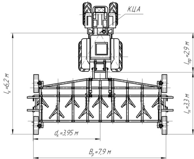
Рисунок 1 – ATLES-946+экспериментальный
